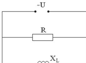
13. Рассчитайте показания приборов до и после замыкания выключателя.
